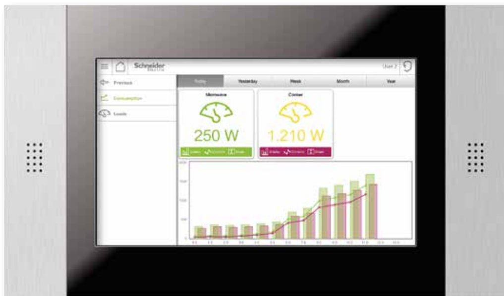
U.motion сенсорная панель 10 Визуализация параметров потребления электроэнергии
