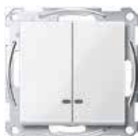
2 клавишный выключатель, с подсветкой (красного цвета), без рамки, сх.1, 10 А, 250 В пер. тока
